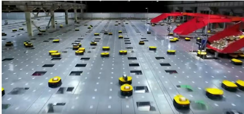
FIGURE 1.12 – Optimisation des trajectoires de robots dans les entrepôts de stockage de l’entreprise de livraison chinoise Shengton.
