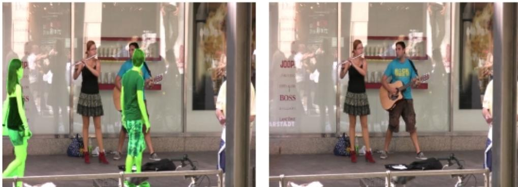
FIGURE 1 – Exemple d'inpainting sur une image d'une vidéo. À gauche, l'image originale avec en vert les personnes à enlever. À droite le résultat de l'algorithme.
