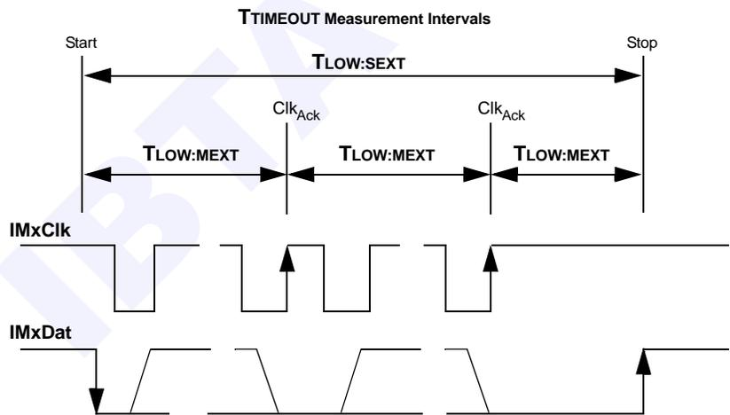
**Figure 175 IMxDat, IMxClk  $t_{\text{TIMEOUT}}$  Measurement Intervals**
