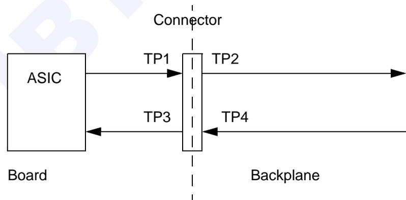
Figure 33 Board/Backplane test points
