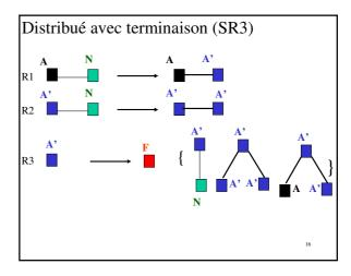
Théorème: le système SR3 calcule un arbre recouvrant avec détection locale de la terminaison globale
