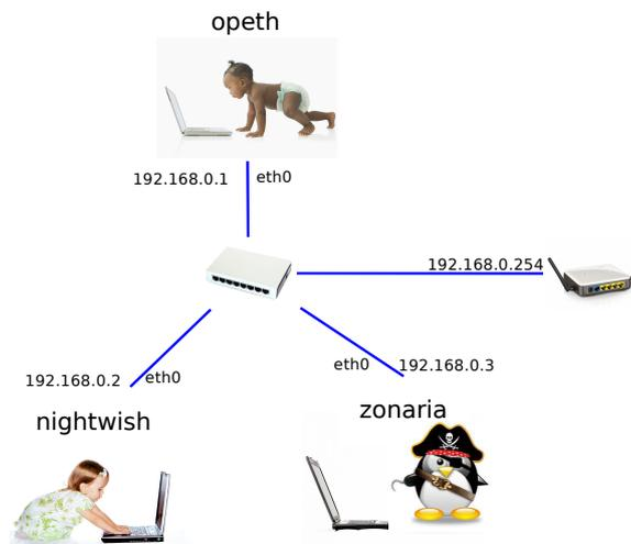
Nous pouvons constater que ce réseau est composé de 3 machines et un routeur DHCP/DNS. Les 3 machines nommées sont des terminaux utilisateurs standards tournant sous *Debian* et inter-connectées grâce à un switch sur lequel une *box* est présente. Les machines virtuelles vous sont livrées *nues*. C'est à dire qu'elles disposent uniquement des réglages élémentaires du système. Le mot de passe *root* est **plop**.
