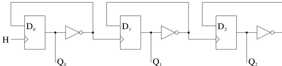
Tracer un chronogramme représentant l'évolution des états de  $H$ ,  $Q_0$ ,  $Q_1$  et  $Q_2$  au cours du temps sur onze cycles d'horloge. On supposera que l'état initial des bascules est 0, et on négligera la dérive de l'horloge. Soit  $Q$  le mot binaire à trois bits constitué des bits  $Q_2Q_1Q_0$  (le bit 0 est toujours le bit de poids le plus faible). Au vu du chronogramme, quelle fonction ce circuit remplit-il ?
