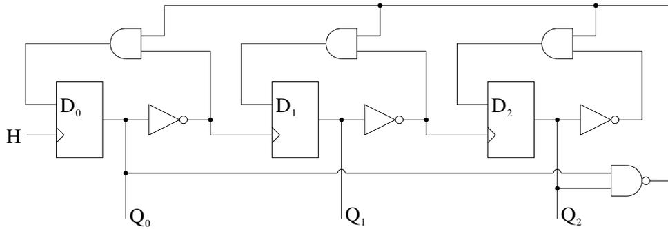
Tracer un chronogramme représentant l'évolution des états de  $H$ ,  $Q_0$ ,  $Q_1$  et  $Q_2$  au cours du temps sur onze cycles d'horloge. On supposera que l'état initial des bascules est 0, et on négligera la dérive de l'horloge. Soit  $Q$  le mot binaire à trois bits constitué des bits  $Q_2Q_1Q_0$  (le bit 0 est toujours le bit de poids le plus faible). Au vu du chronogramme, quelle fonction ce circuit remplit-il ?
