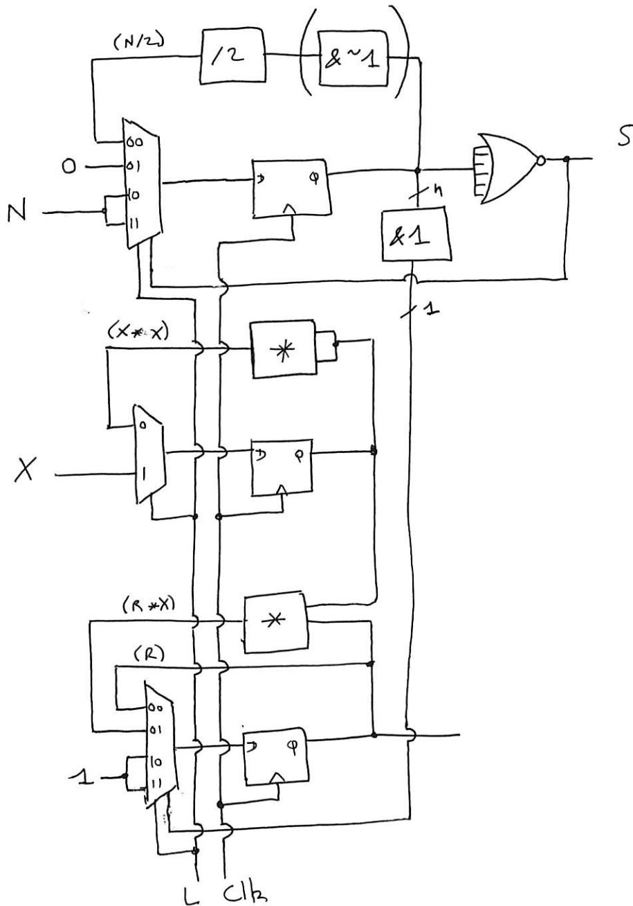
Le bloc  $\begin{array}{|c|} \hline \& 1 \\ \hline \end{array}$  prend la valeur du fil du bit de poids le plus faible.
