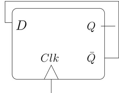
**Q2** Déduisez-en une façon de réaliser un circuit “diviseur de fréquence” qui accepte en entrée un signal d’horloge ainsi qu’un bit de commande (0 = normal, 1 = slow) et qui fournit en sortie soit le signal d’horloge inchangé (mode normal) soit un signal d’horloge de période deux fois plus longue (mode slow).
